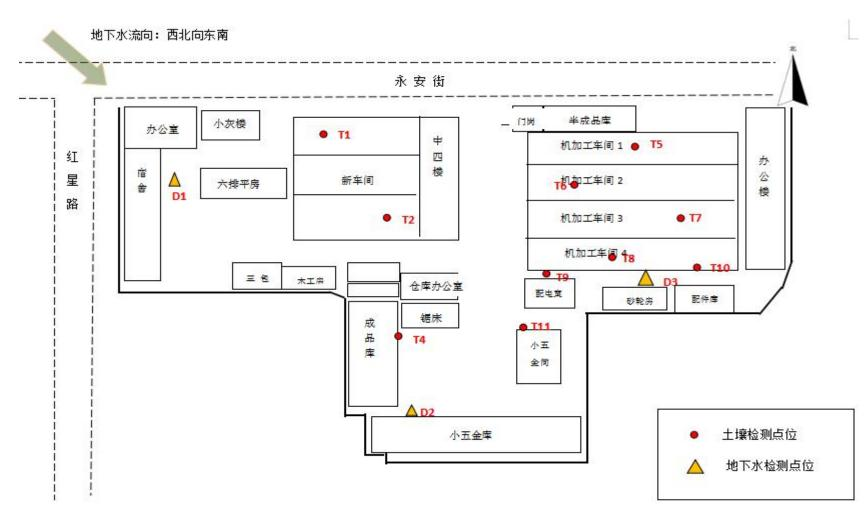
图 3-1 调查地块土壤、地下水采样布点图
