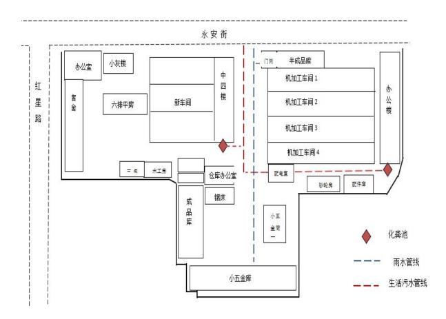
图 2-15 调查地块污水管线走向图
