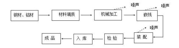
图 2-12 高频附着式振动器和铁路小型养护机械系列的生产工艺流程图工艺说明:
